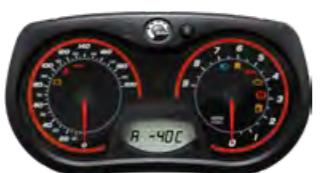
**OMGIVELSESLUFT- OG MOTORETEMPERATURMODUL**
